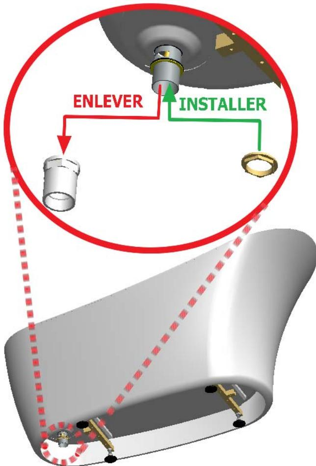
**8.** Installer le ITD35 en suivant les instructions d'installation livrées avec celui-ci.
