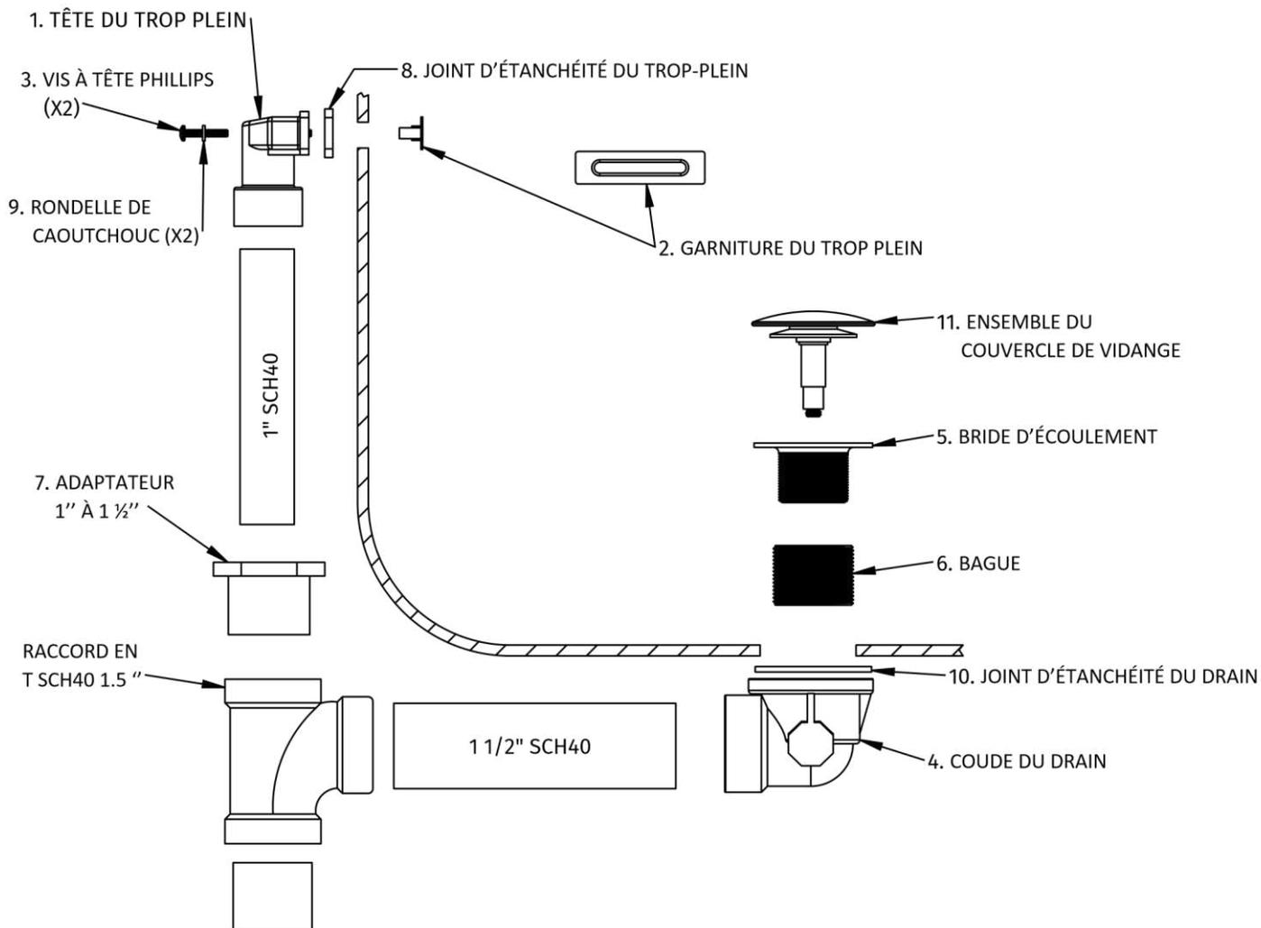
1. FIXER LA TÊTE DU TROP-PLEIN (1) SUR LE TUBE À L'AIDE DE LA GARNITURE DU TROP-PLEIN (2) ET DES DEUX VIS À TÊTE PHILLIPS (3).
