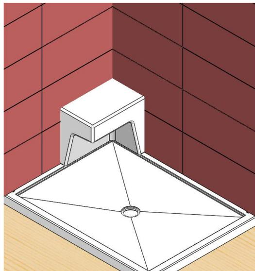
**9.** Une fois la céramique posée, appliquer un trait de silicone entre la base et la céramique mais laisser une ouverture minimale de 1/2" (12.7 mm) entre l'intérieur de la base et la barrière.
