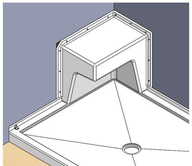
**7.** Coller une membrane d'étanchéité (non fournie par Océania) sur le gypse et la bride de carrelage. La membrane doit avoir un contact d'environ 5" (127mm) avec le gypse et de 1" (25.4mm) avec la bride de carrelage. Il est de la responsabilité de l'installateur de bien sceller la jonction entre la feuille de gypse et la bride de carrelage.
