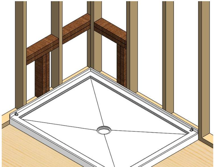
**3.** Placer le siège en position, bien appuyé sur la base de douche et sur les montants. Percer avec une mèche 1/8" la bride de carrelage vis-à-vis les montants (2x4). Ne pas percer dans les montants.
