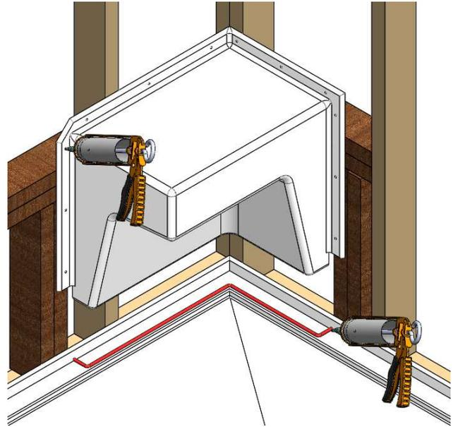
**5.** Placer et fixer le siège avec des vis #8 de 1 1/2" de longueur. Éviter de serrer les vis trop fort, cela pourrait briser les brides de carrelage.
