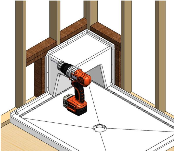
**4.** Retirer le siège, appliquer un trait de silicone sur la base de douche et dans chacun des trous de la bride de carrelage.
