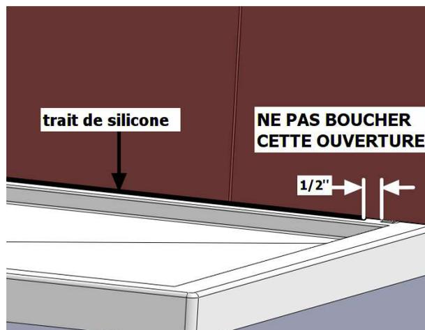
**10.** Remplir de silicone la partie extérieure de l'ouverture (celle entre l'extérieur de la base et la barrière). Insister pour que le silicone monte derrière la céramique. Laisser sécher ou recouvrir de silicone frais avant d'installer les portes.
