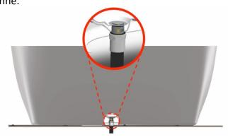
**5.** Appliquer du silicone sous les 4 pattes du bain et la colle appropriée sur le joint de raccordement (fait en PVC). Raccorder le bain à sa position finale.
