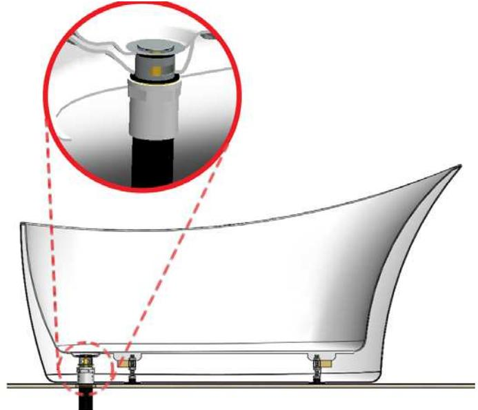
**5.** Appliquer du silicone sous les 4 pattes du bain et la colle appropriée sur le joint de raccordement (fait en PVC). Raccorder le bain à sa position finale.
