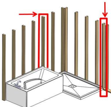
**8.** Fixer le bain au mur. Pour se faire, percer la bride avant de visser. Le trou percé doit être plus gros que le diamètre de la vis.
