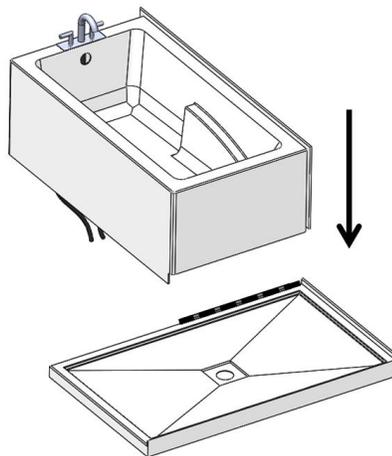
**7.** S'assurer qu'il y a un montant à ces endroits (à l'extrémité de la base et vis-à-vis la tablette du bain). Ceci servira lors de l'installation des moulures de la porte de douche.
