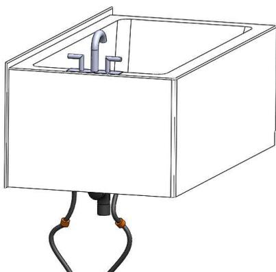
**4.** Installer le bain sur des blocs à l'endroit où il sera positionné. Faire les connections nécessaires (eau chaude/froide, lumière de chromothérapie, clavier, détecteur d'eau, souffleur). Le souffleur peut être relocalisé ailleurs que sous la jupe pour permettre un accès facile.
