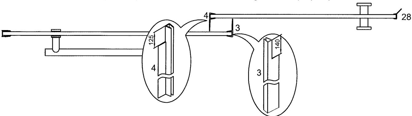
Installer le joint d'étanchéité pour porte II (28) sur la porte coulissante (26). Avant d'installer le joint d'étanchéité du panneau fixe (3) sur le panneau fixe (8), couper en haut du joint une tranche de 140mm. Avant d'installer le joint d'étanchéité pour porte I (4) sur la porte coulissante (26), couper en haut du joint une tranche de 125mm. Cela permettra aux roues (25) de passer.
