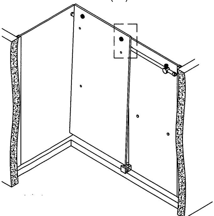
Insérer la porte coulissante (26) dans la douche en faisant très attention. Soulever la porte afin d'embarquer les roues (25) sur le tube (15) et la déposer soigneusement dans le guide (5).
