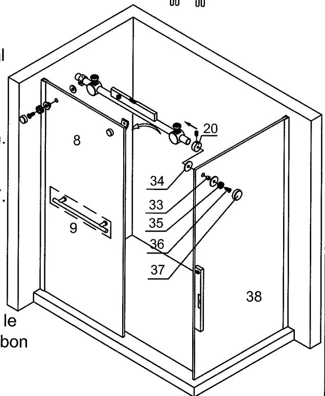
Fixer le tube (15) au panneau fixe (8) en utilisant le support I (13) et les items 20-34-33-34-35-36-37. Mettre le tube (15) au niveau en ajustant les écrous d'ajustement des supports I et II (13, 14) avec la clé d'ajustement (31). Mettre le panneau latéral fixe (38) au niveau et fixer le tube (15) en place afin de garder le panneau d'équerre. Après, installer le porte-serviette (9) sur le panneau fixe (8) en vous assurant de le mettre du bon côté.
