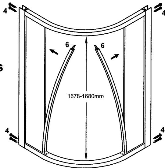
Insérer le rail inférieur (10) et le rail supérieur (12) dans les panneaux fixes (5). S'assurer que la distance entre les deux rails est de 1678-1680mm. Ensuite, fixer avec les vis phillips ST4 X 30 (4). Finalement, insérer les joints d'étanchéité des panneaux fixes (6) sur les panneaux fixes (5).
