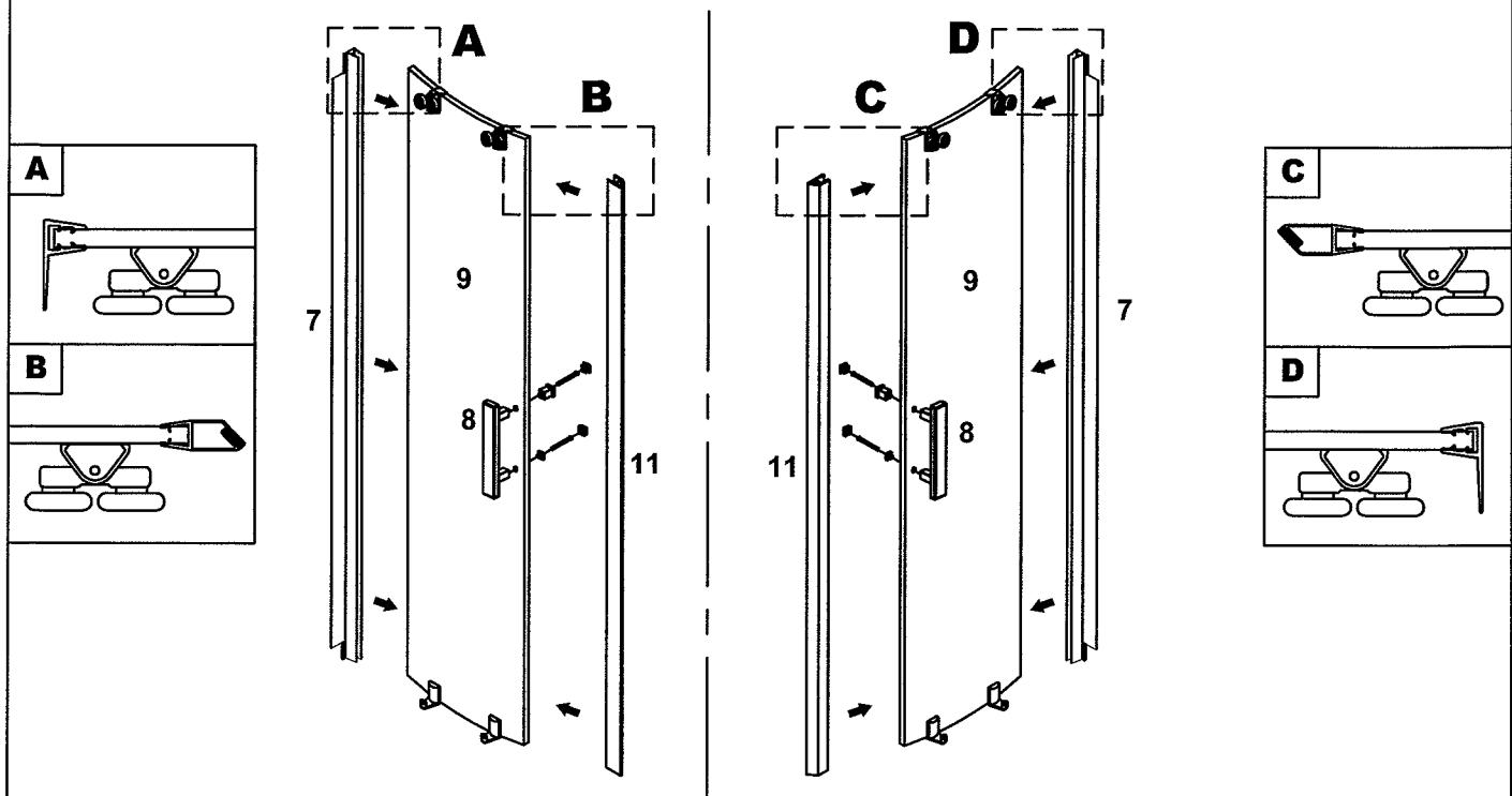
Assembler les joints d'étanchéité (7) et les bandes magnétiques (11) aux portes (9). Installer les poignées (8) sur les portes en vous assurant de les mettre sur le bon côté.
