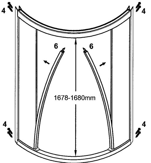
Insérer le rail inférieur (10) et le rail supérieur (12) dans les panneaux fixes (5). S'assurer que la distance entre les deux rails est de 1678-1680mm. Ensuite, fixer avec les vis phillips ST4 X 30 (4). Finalement, insérer les joints d'étanchéité des panneaux fixes (6) sur les panneaux fixes (5).
