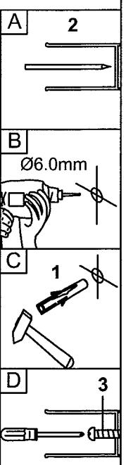
Mettre l'assemblage du châssis sur le dessus de la douche et mettre au niveau. Avec un crayon, marquer l'emplacement des jambages pour panneaux fixes (2). Ensuite, enlever le châssis et mettre les jambages (2) sur les marques. Tracer l'emplacement des trous et percer avec une mèche 6mm. À l'aide d'un marteau, mettre les ancrages(1) et finalement serrer les jambages (2) avec les vis phillips ST4 X 50 (3).
