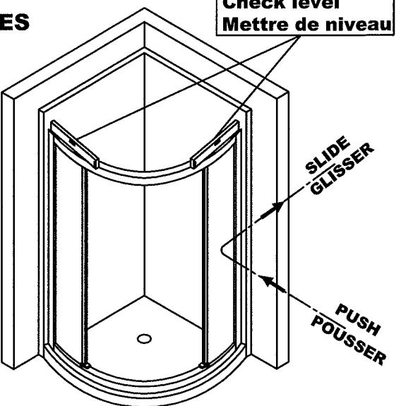
Tout en supportant le châssis, le glisser jusqu'au fond sur le jambage (2). Soulever l'autre côté du châssis avec soin et l'insérer sur l'autre jambage (2).
