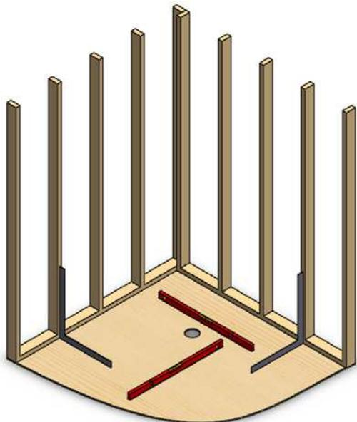
2. Installer maintenant de façon temporaire votre base de douche dans son emplacement final, parfaitement au niveau. Utiliser des cales d'espacement pour mettre la base au niveau (bardeau de cèdre). S'assurer que les cales sont situées à des endroits rigides en dessous de la base.
