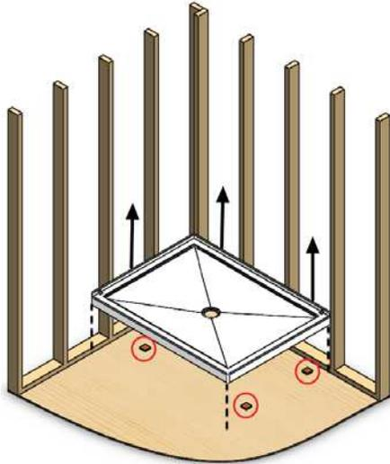
**4.** Mettre un adhésif de construction (de type PL) sur toutes les surfaces de contact entre la base et le sol.
