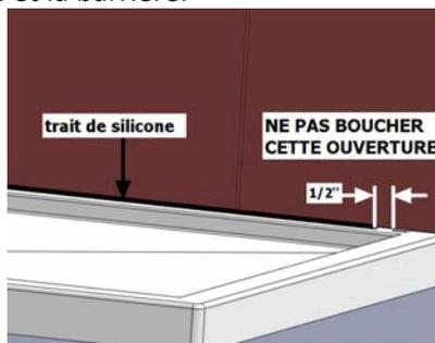
**10.** Remplir de silicone la partie extérieure de l'ouverture (celle entre l'extérieur de la base et la barrière). Insister pour que le silicone monte derrière la céramique.
