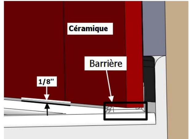
**9.** Une fois la céramique posée, appliquer un trait de silicone entre la base et la céramique mais laisser une ouverture minimale de 1/2" (12.7 mm) entre l'intérieur de la base et la barrière.
