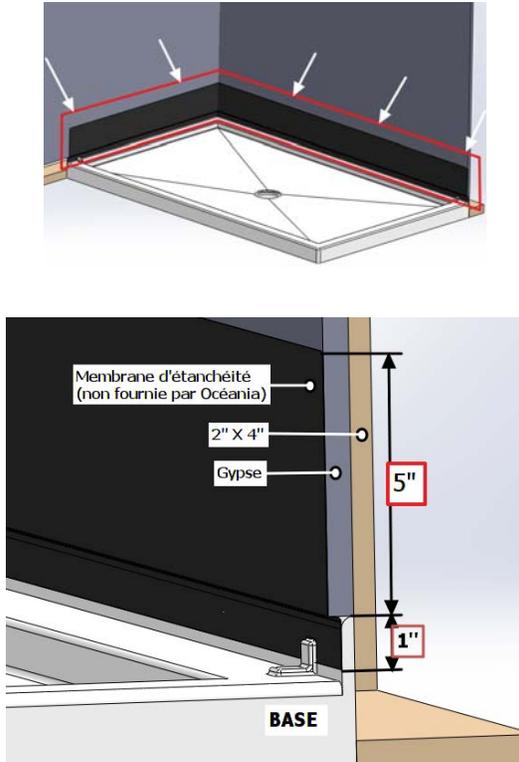
**8.** Compléter le revêtement mural. Pour se faire, il faut asseoir la céramique sur la barrière d'étanchéité conçue à cet effet. Aligner la céramique afin de créer une petite ouverture entre la céramique et la base. Cette ouverture est d'environ 1/8" (3.2 mm).
