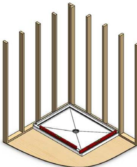
**3.** Soulever la base délicatement afin de ne pas déplacer les cales qui resteront sur le sol. Mettre un adhésif de construction (de type PL) sur les cales afin qu'elles ne bougent pas lors des manipulations. Au besoin, procéder à l'installation du renvoi sur la base.
